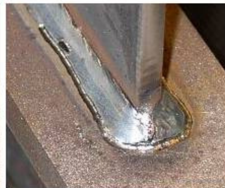
Aufgeschweißte Längssteife nach der HiFIT-Behandlung
