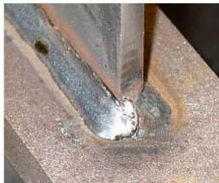
Aufgeschweißte Längssteife vor der HiFIT-Behandlung
